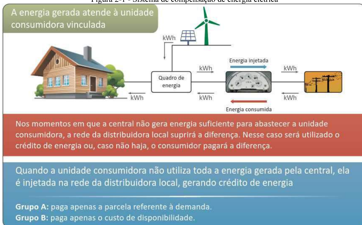
Figura 2-1 - Sistema de compensação de energia elétrica
