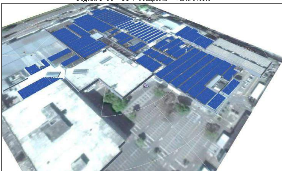
Figura 5-16 - UFV completa - Vista Norte
