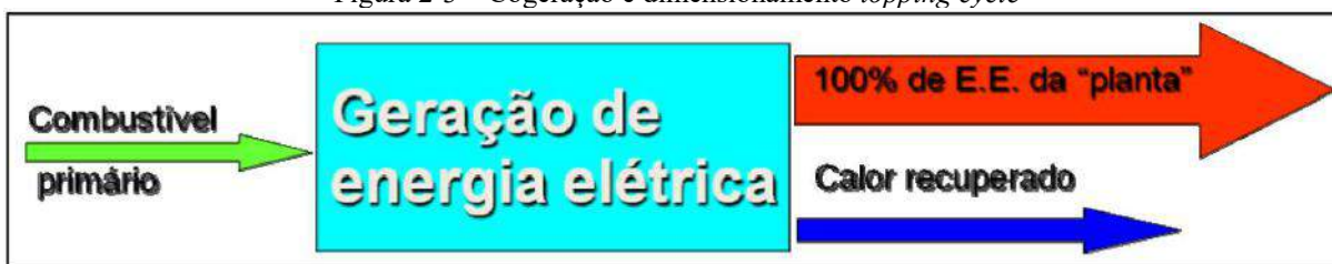
Figura 2-3 – Cogeração e dimensionamento topping cycle
